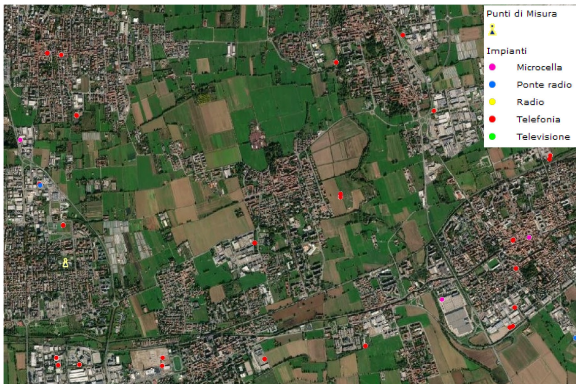
Localizzazione delle sorgenti di onde elettromagnetiche (ARPA Lombardia Catasto Radio Impianti)
